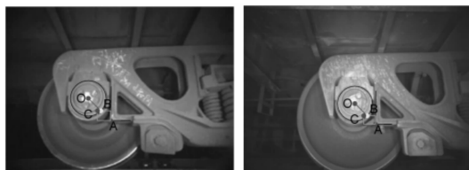
图10 类似 K2 转向架的 ROI 标定
